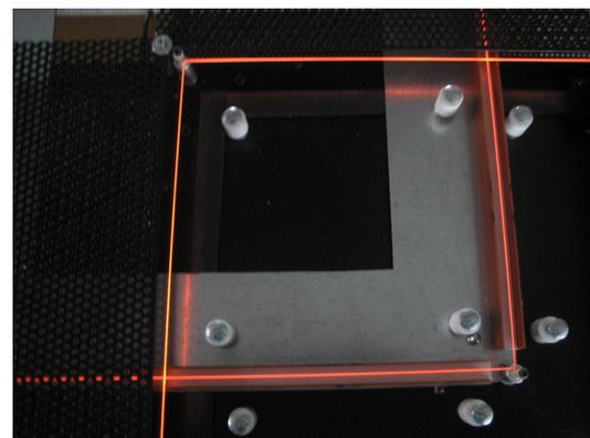
Piccola riscaldatrice da banco per piegare scatole, sia di forma quadrata che di forma rettangolare, con misura minima 90 x 90mm e massima 450 x 450mm.
