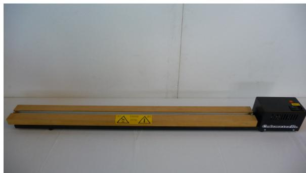
Dotata di una resistenza a filo con lunghezza utile di 1000 mm e apertura fissa della zona irraggiata pari a 11 mm è in grado di riscaldare lastre di materiale di spessore da 0.5 a 4 mm.
