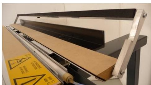
Dotata di una resistenza a quarzo con lunghezza utile di 1000 mm e apertura regolabile della zona irraggiata da 5 a 35 mm è in grado di riscaldare lastre di materiale di spessore da 1.5 a 10mm. (ottimale 8mm).
