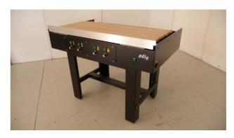
Non necessita di gruppo di raffreddamento. Alimentazione a 220 Volt monofase. Alimentazione resistenza a bassa tensione.
