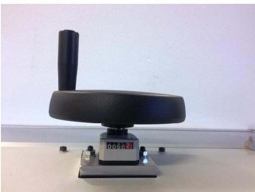
Il gruppo superiore è autolivellante per supportare la differenza degli spessori del materiale. Azionando il volantino è possibile lavorare materiali da 3 mm a 60 mm.
