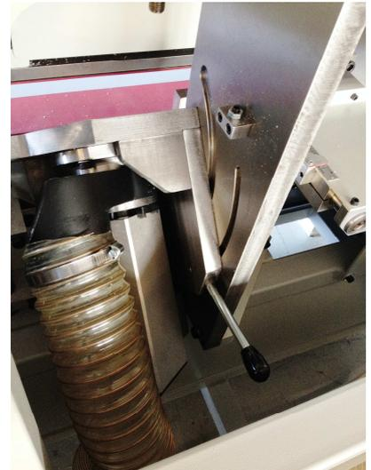
Per il cambiamento dei gradi di lavorazione e per variare gli spessori è stato realizzato un sistema molto semplice e veloce così da eliminare i tempi morti di lavorazione per cambio formati.
